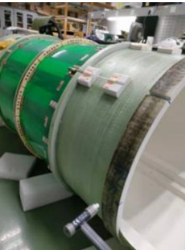
核磁共振仪锤击法测试
